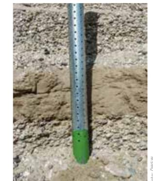
Rammspitze mit Filterrohr
