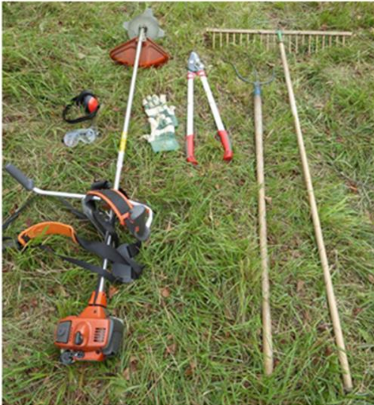
Abb. 5: Verwendete Arbeitsmaterialien und Motorsense – geeignetster Einsatz bei Bodenunebenheiten (© H. Moser-Sturm)
